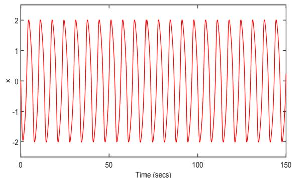
Fig. 1. Oscillations of Van der Pol oscillator
