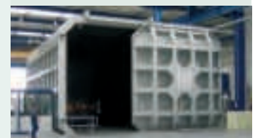
■ Vakuum-Elektronenstrahl-Schweißanlage, 630 m 3 Kammervolumen
