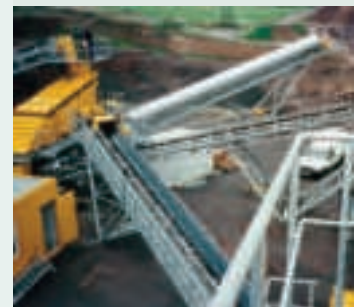
■ Haldenband (höhenverstellbar, schwenkbar)
