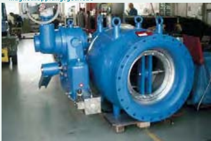
■ Ringkolbenventil DN 800 mit Magnetkupplungsgetriebe
